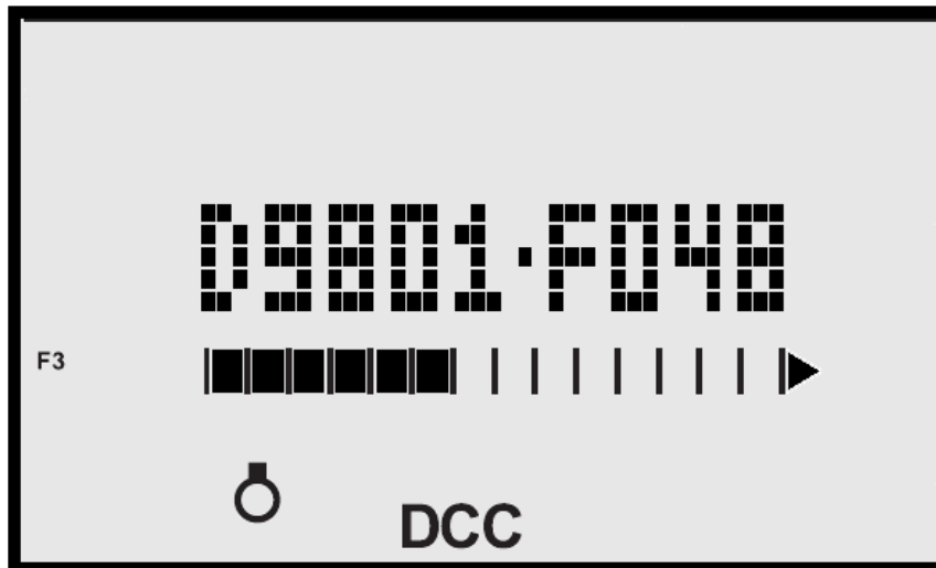
Beispiel – Darstellung einer DCC-Lok mit langer Adresse und 126 Fahrstufen
