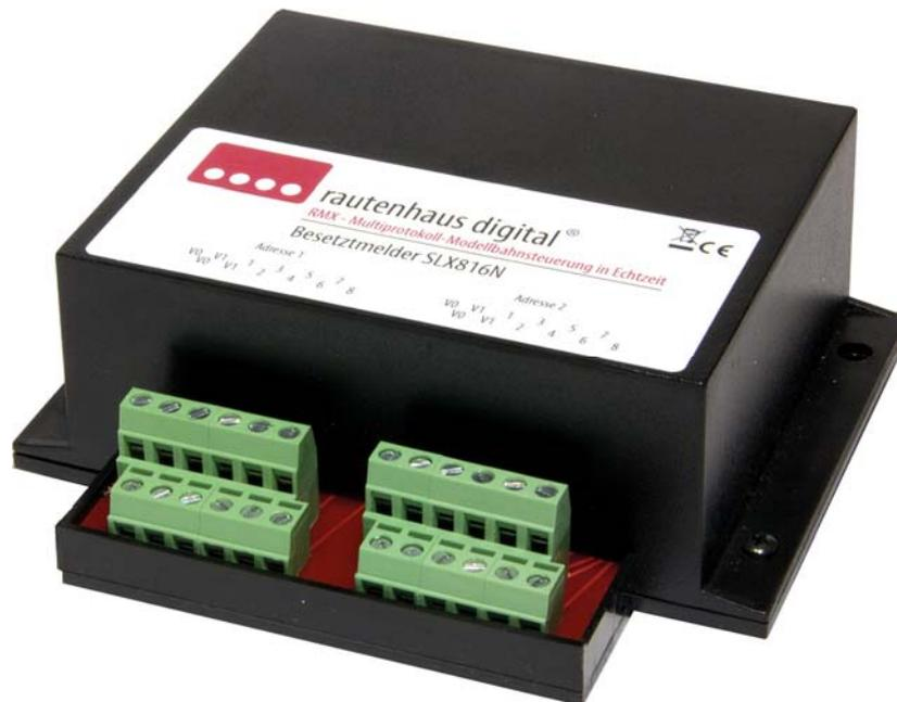
Neuer überarbeiteter Besetzmelder mit updatefähigem Prozessor, RMX7-, RMX1-, SX0 sowie SX1 kompatibler 7-poligen Busanschlussbuchsen und verstärkter Ausgangsbelastbarkeit bis 4A. Besetzmelder zum Überwachen und Melden von bis zu 16 Gleisabschnitten.
