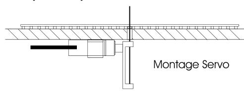
**Vorbereitungen für Einbau des Servos:** Zum Einbau des Sevos benötigen Sie eine Bohrung in Ihrer Stellschelle von 0,8 bis 1mm Durchmesser. Bringen Sie nun die Weiche in Mittelstellung und bohren Sie ein Loch von ca. 10 mm oder ein Langloch von ca. 10 x 5mm in Ihre Anlagenplatte unterhalb der Stellschwelle.
