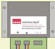
Für eine fehlerfreie Funktion muss der Mikrokurzschluss einwandfrei wirken. Dazu ist der Fahrstrom jeweils in der Nähe der beiden beidseitigen Gleisisolierungen einzuspeisen!
